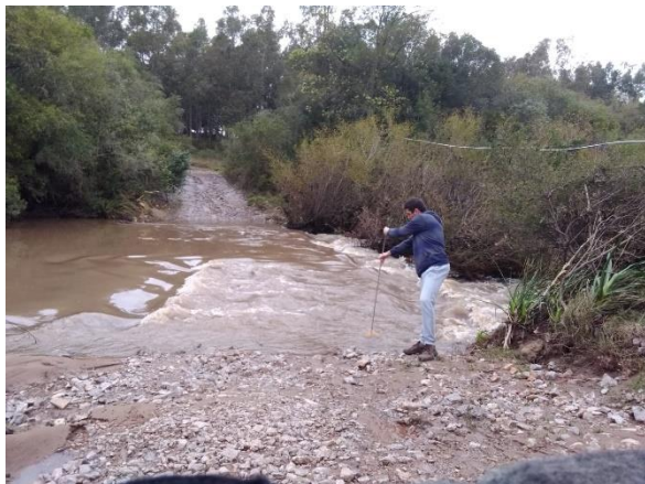
Figura 1 - Coleta de amostra para análise de sólidos em suspensão com o amostrador DH-48. Fonte: Ecossis, 2021.
